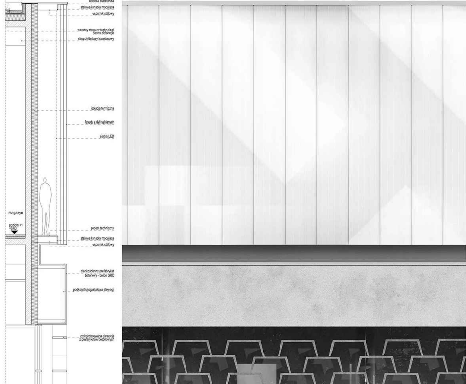
detal fasady nadbudowy dawniej części restauracyjnej | 1:50
