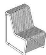
modułowe siedzisko z oparciem z prętów stalowych 1:20 50 x 80 x 70 cm
