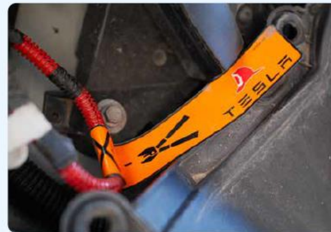
Przewody przeznaczone do przepięcia
